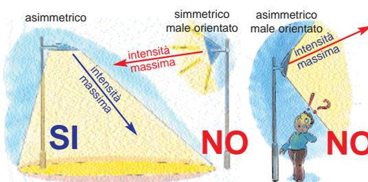
Proiettori simmetrici ed asimmetrici sono entrambi utilizzabili ma solo se installati con vetro piano orizzontale
