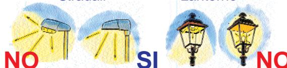
Usare solo apparecchi installati con vetro piano e orizzontale. Le lanterne devono avere lampade recesso nel vano ottico, e devono essere senza vetri laterali (solo vetro piano orizzontale)
