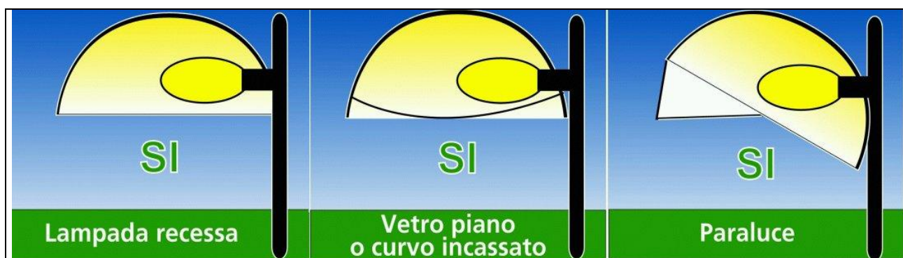
Fig.2 – Apparecchi conformi alla L.r. 17/09.
