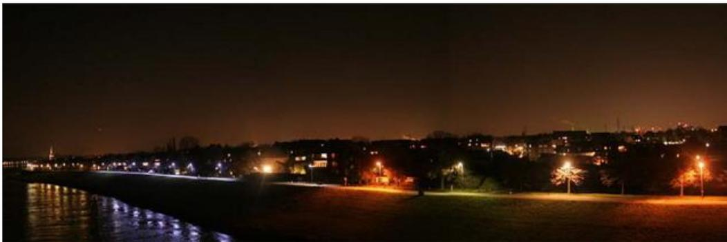
Ecco infine evidenziate le differenze su una pista ciclabile illuminata con tutte le tecniche: led (Sorgenti blu) 6000°K, gli ioduri metallici a bruciatore ceramico di nuova generazione (giallo chiaro) 3300°K, il sodio alta pressione (tendente al giallo-rosa) 2000°K ed il vecchio mercurio (verde) 4500°K.
