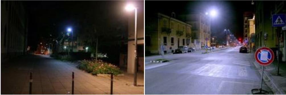
E' evidente anche la differenza nell'immagine in basso a sinistra fra una luce a led da 5500°K ed una a ioduri metallici a bruciatore ceramico di nuova generazione (bianco-giallo) da 3300°K in primo piano.
